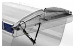
zeichnet sich durch wenig bewegte Bauteile – hohe Betriebssicherheit – geringe Stromaufnahme ca. 16 A – schnelle und einfache Montage bzw. Demontage – freien Einstieg – Zeitersparnis; Öffnungs-/ Schließzeiten von 25 Sekunden aus. Interessierte können AIRpipe auf der Homepage [www.airpipe.at](http://www.airpipe.at) besuchen oder auf der IAA Transportation vom 20. 9. 2022 bis 25.9.2022, Halle 25 an Stand E41 in Hannover. (cb)
