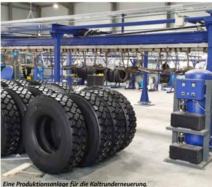
Eine Produktionsanlage für die Kaltrunderneuerung.
