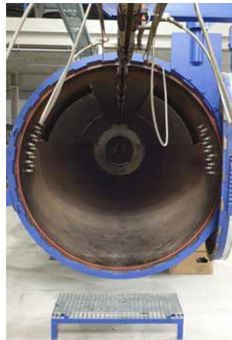
Die Draufsicht auf die geöffnete „Tonne“ zeigt einen Autoklav: In dem so genannten, gasdicht verschließbaren Druckbehälter wird in der Kalterneuerung die Verbindung zwischen Karkasse, Bindgummi und Laufstreifen hergestellt. Fotos: BRV
