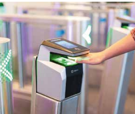
Berührungslose Systeme wie der 3D-Fingerscan MorphoWave erkennen eine Hand im Vorbeigehen in weniger als einer Sekunde.
